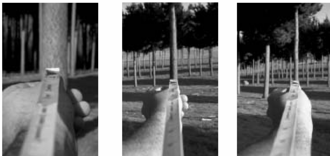
202 203 Figura 3. Medición de área basimétrica con DendroFlexómetro© 204
